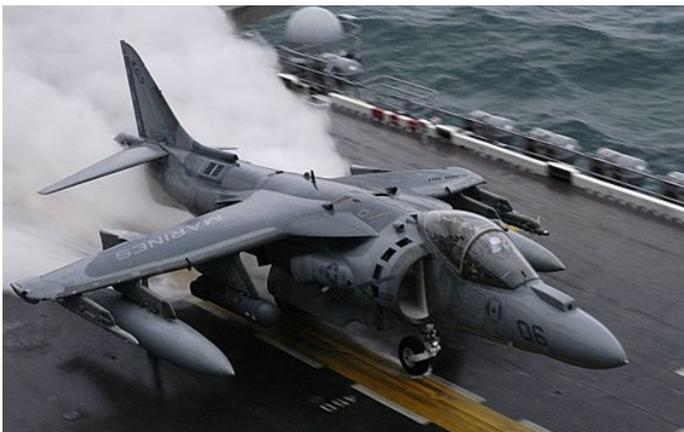
*Courte mais spectaculaire course au décollage pour un AV-8BII+ de l'USMC sur le pont humide d'un porte-aéronefs. Le souffle brûlant des 4 tuyères principales est clairement matérialisé par l'humidité vaporisée.*
