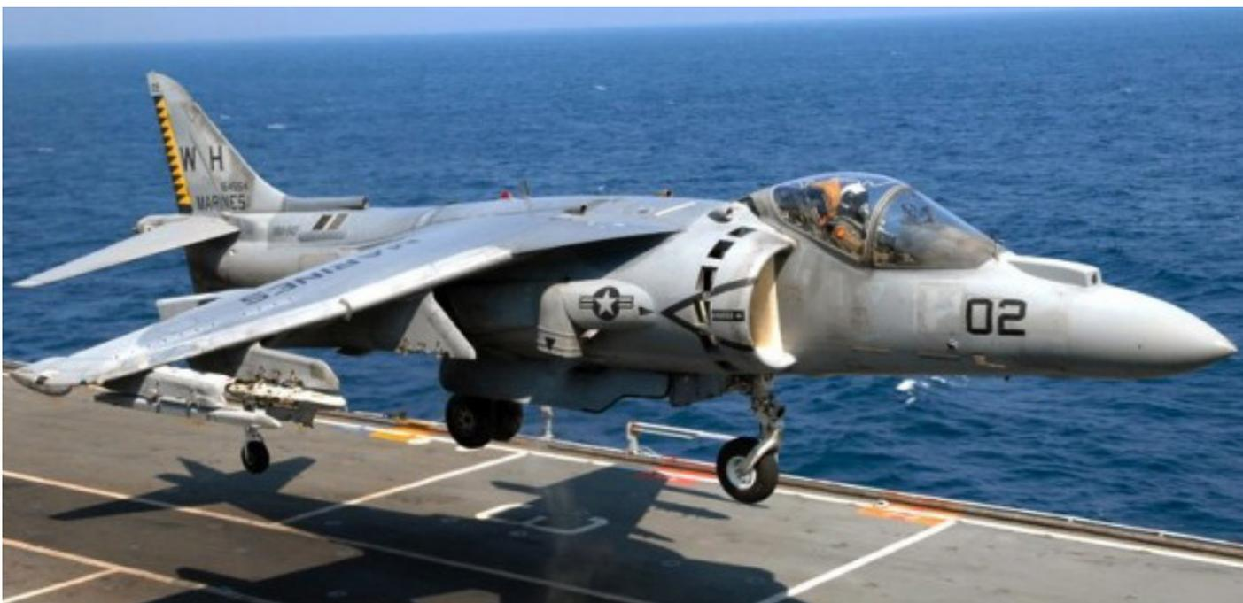
*Atterrissage vertical d'un AV-8BII+ sur un porte-aéronefs de l'USMC. Sous l'emplanture de l'aile, l'une des 4 tuyères principales, orientées vers le bas lors de cette manœuvre, est clairement visible.*
